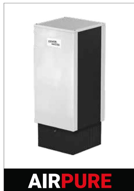
**AIRPURE** est une solution qui peut être utilisée comme purificateur ou aspirateur d'air ambiant. Équipé d'un ventilateur à vitesse variable, il filtre l'air de 200 à 3000 m<sup>3</sup>/heure et recycle l'air potentiellement contaminé d'une pièce. Il est totalement autonome, silencieux et facilement déplaçable. Avec 5 niveaux de filtration, il aspire l'air par le bas et le rejette par le haut.
