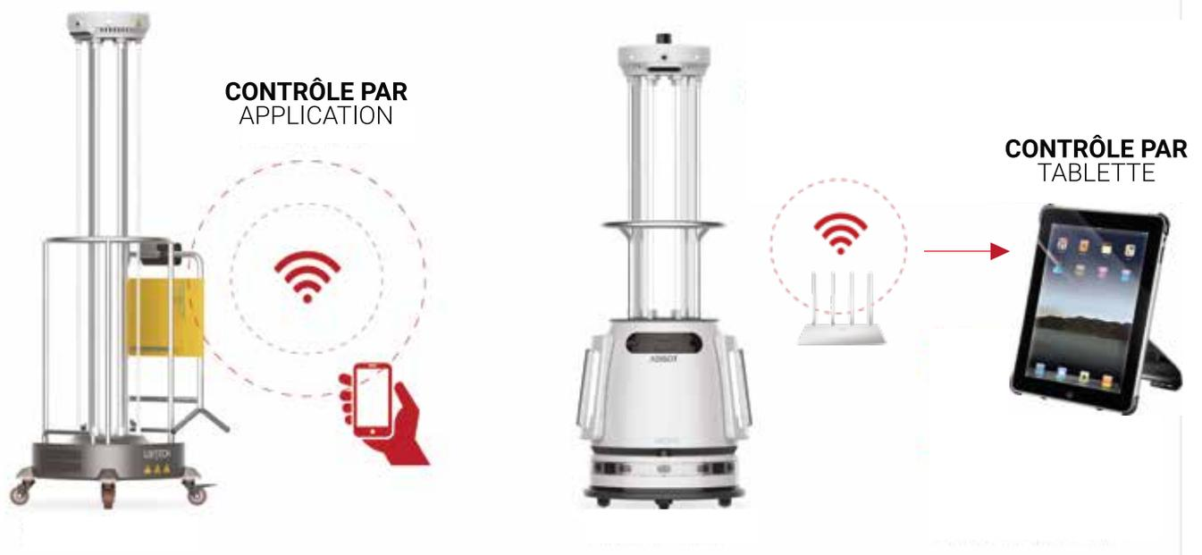
**ADIBOT** avec intégration sécurisée et mobile. Le Wi-Fi intégré de l'ADIBOT-S permet une connexion directe à l'app propriétaire pour la configuration, l'analyse et la gestion des tâches. Les robots ADIBOT peuvent ainsi être utilisés de manière sûre, fiable et autonome.
